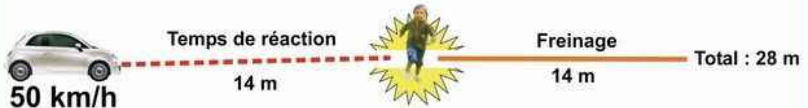
( Temps de réaction : Environ 1 s - Freinage par temps sec )
