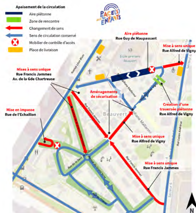
Extrait d'un plan de circulation mis en oeuvre en 2023, dans un quartier à 30 km/h de Grenoble, dans le cadre du projet « places aux enfants » de l'école Beauvert, devenue piétonne. Les 3 artères à l'ouest, l'est et au sud sont à 50 km/h avec des lignes de bus structurantes.
