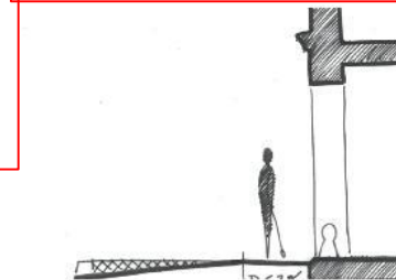
La pente d'accès du véhicule, au-delà de la zone de dévers de moins de 2%, est à calibrer en fonction de la largeur du trottoir, et la hauteur de bordure.
