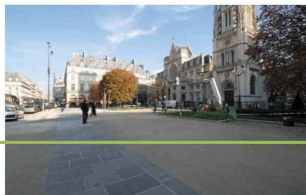
Guidage intuitif apporté par une différence de revêtements (parvis église Saint-Germain l'Auxerrois, 1 er )
