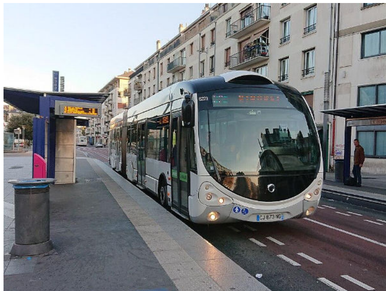
BHNS guidé à l'accostage par un système optique
